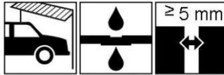
für leichte Verkehrsbelastung    wasserdurchlässig     $FB \geq 5\text{mm}$
